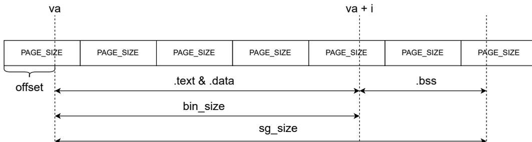
图 3.2: 每个 segment 的加载地址布局
