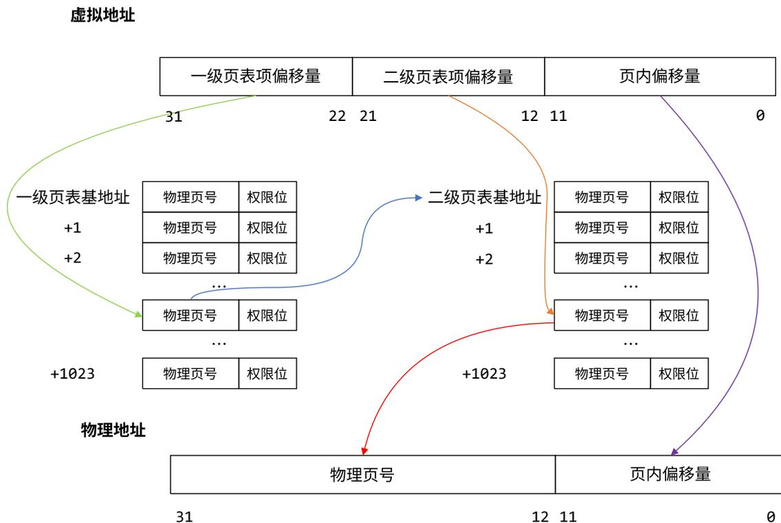
图 2.4: 两级页表结构的地址变换机制
